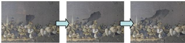
Les deux couches de sol sont mises en place dans une cellule puis soumises à i) une contrainte mécanique verticale reproduisant les contraintes *in-situ* ii) un écoulement à débit imposé, augmenté par paliers successifs. L'analyse de la quantité de sol fin érodé et transporté hors de l'échantillon au cours de l'essai permet d'évaluer la résistance à l'érosion de ce couple sol fin/sol grossier.
